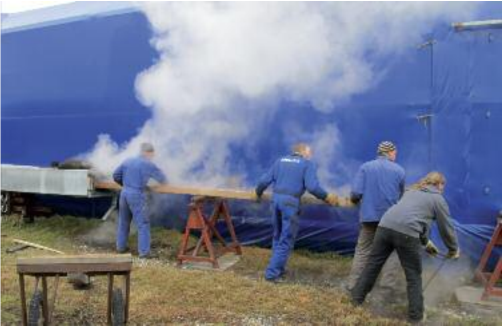
BONAVISTA er ved at være planket op. Her hales en af de sidste planker ud af svedekisten på byggepladsen på Eriksens Plads.
